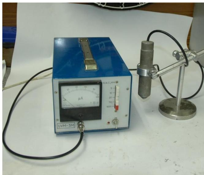
Рис. 2.6. Бесконтактный виброметр БВУ-3М для измерения амплитуды колебательных смещений излучателя ультразвука
