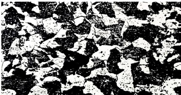
Рис. 4.6. Микроструктура стали 45 в исходном состоянии (×400)
